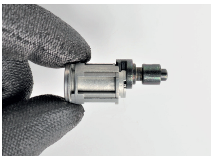
Associer l'ensemble cage d'adaptation et barillet avec l'adaptateur de couleur noire
