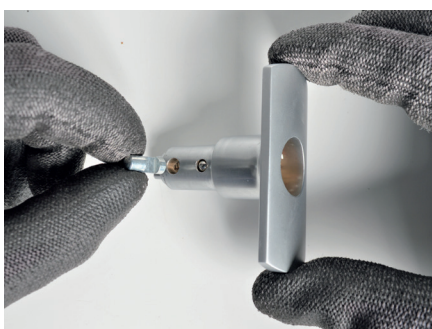
Insérer la goupille avec l'encoche vers l'avant
